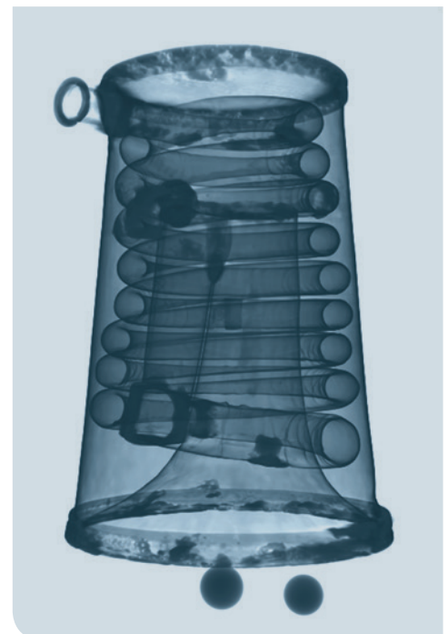
Per CT wird das Innenleben der äußerlich unscheinbaren Büchsentrompete sichtbar. © Fraunhofer EZRT
