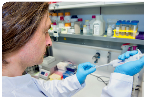
Im Labor wird aus Speichelproben von Vorschulkindern die Erbsubstanz isoliert und für die massenspektrometrische Untersuchung auf Stahlplatten aufgetragen. © Fraunhofer IZI
