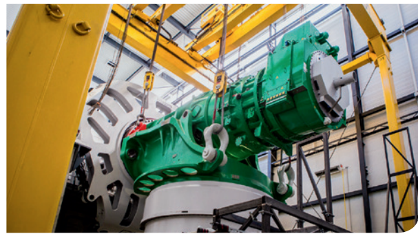
Beim Test im Fraunhofer Dynamic Nacelle Testing Laboratory werden die Lasten von der Rotorseite wie auch Netzschwankungen simuliert. © Adwen
